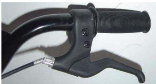
2. Stecken Sie das Seil in die Rille in der Stellschraube des Bremshebels hinein, und lösen Sie die Klemmung der Bremsbacken. Das Bremsseil schaltet anschließend aus und das Endstück des Bowdenkabels rastet in die Stellschraube der Bremse ein.
