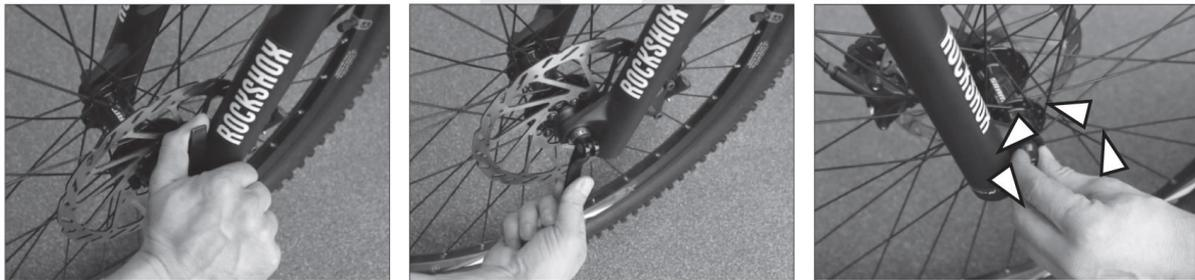
Bei der Fixierung der Räder gehen Sie umgekehrt vor. Wenn Sie die Achse des Schnellspanners komplett ausziehen würden, schieben Sie sie in die Radnabe zurück (passen Sie auf die richtige Orientierung der Federn) und schrauben Sie darauf die Einspannmutter im Uhrzeigersinn. Schließen Sie den Hebel um 90°, ziehen Sie die Mutter im Uhrzeigersinn, bis sie den Widerstand leistet, und danach schließen Sie den Hebel um die übrigen 90°.
