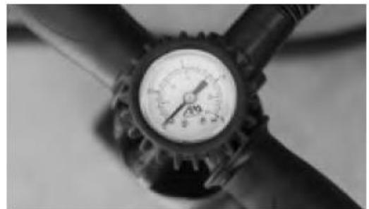
3. Schalten Sie den Druckschlauch in den Druckmesser bis zum Anschlag ein.
